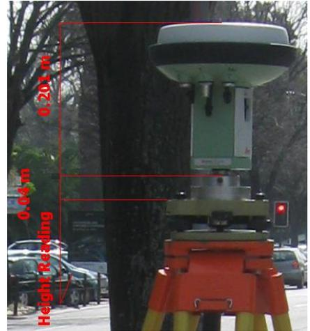
A altura da antena relativamente ao ponto estação (Height Reading) é medida com fita métrica desde o ponto estação até ao local indicado na figura da esquerda (BPA), segundo a vertical
